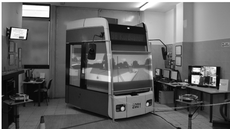
Fot. 1. Stanowisko pierwszego polskiego symulatora tramwaju
