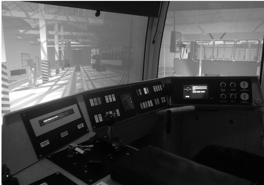
Fot. 2. Wnętrze kabiny i projekcja scenarii na ekranach
